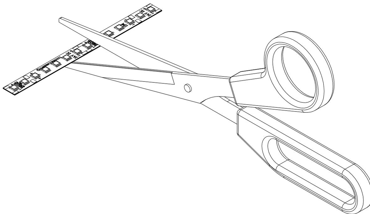
Die LumiFlex Economy 350 LED-Module können alle 100 mm getrennt bzw. gekürzt werden. Auf der Rückseite des LED-Moduls befindet sich ein doppelseitiges wärmeleitendes Klebeband, wodurch eine einfache und schnelle Montage des LED-Moduls möglich ist. Dadurch können Sie nahezu alle Flächen und Formen direkt oder indirekt beleuchten. Zum Kürzen der LumiFlex Economy LED-Module kann eine Schere verwendet werden.
