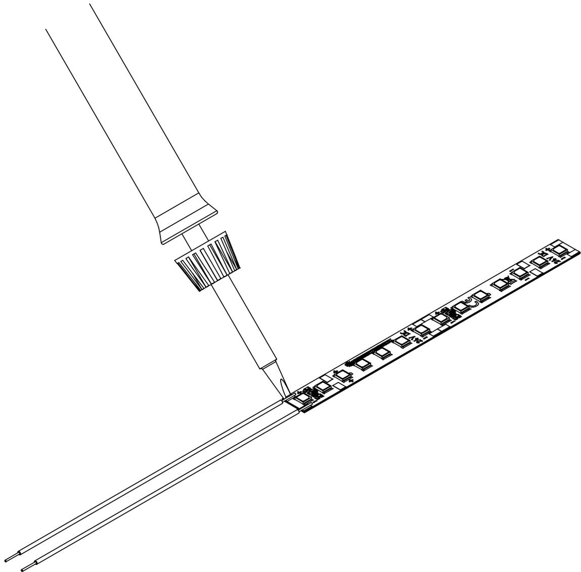
Der Anschluss der LumiFlex700 Pro LED Module erfolgt über eine Lötverbindung an den dafür vorgesehenen Anschluss pads.
